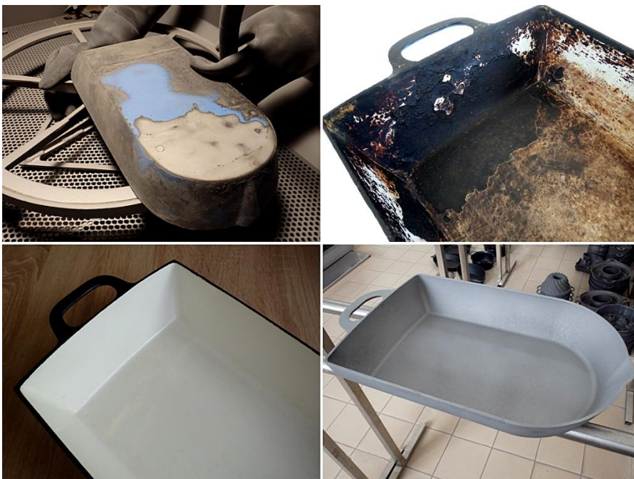
Bild 5: Neuemaillierung einer Bratreine
