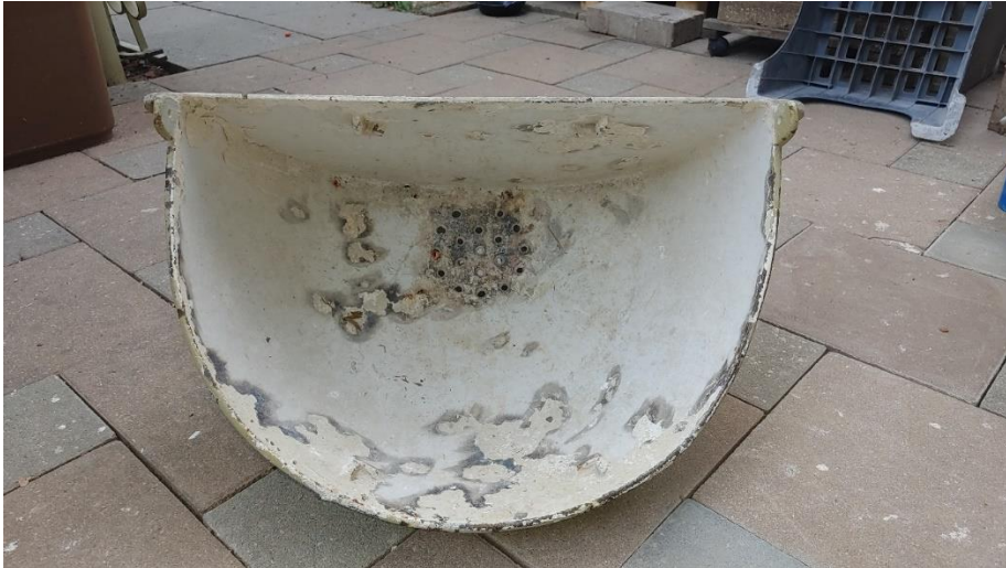
Bild 4: altes Waschbecken im Anlieferungszustand
