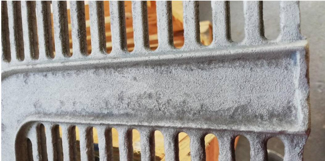
Bild 3: Korrosionsschäden an Gusseisen
