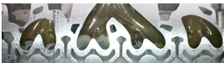
Abbildung 3: Ansicht des Schnittes durch einen Auslasskanalbereich mit Emailbeschichtung. Bereiche der Ventilführung wurden partiell maskiert.
