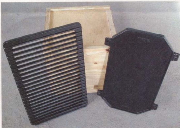
Bild 1: Grillrost und Grillplatte aus der Legierung AlSi12 (Kokillenguss), die emailliert wurden. Die Emailsicht schützt vor Verschleiß und erleichtert die Teilereinigung.
